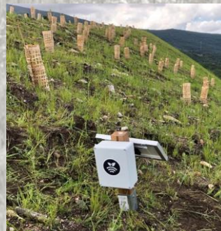
Detalle de los sensores de humedad colocados en el vertedero
